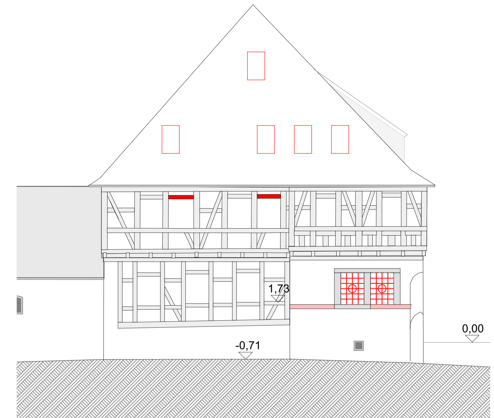
HG Westfassade mit Neubau (rot) 1:100
