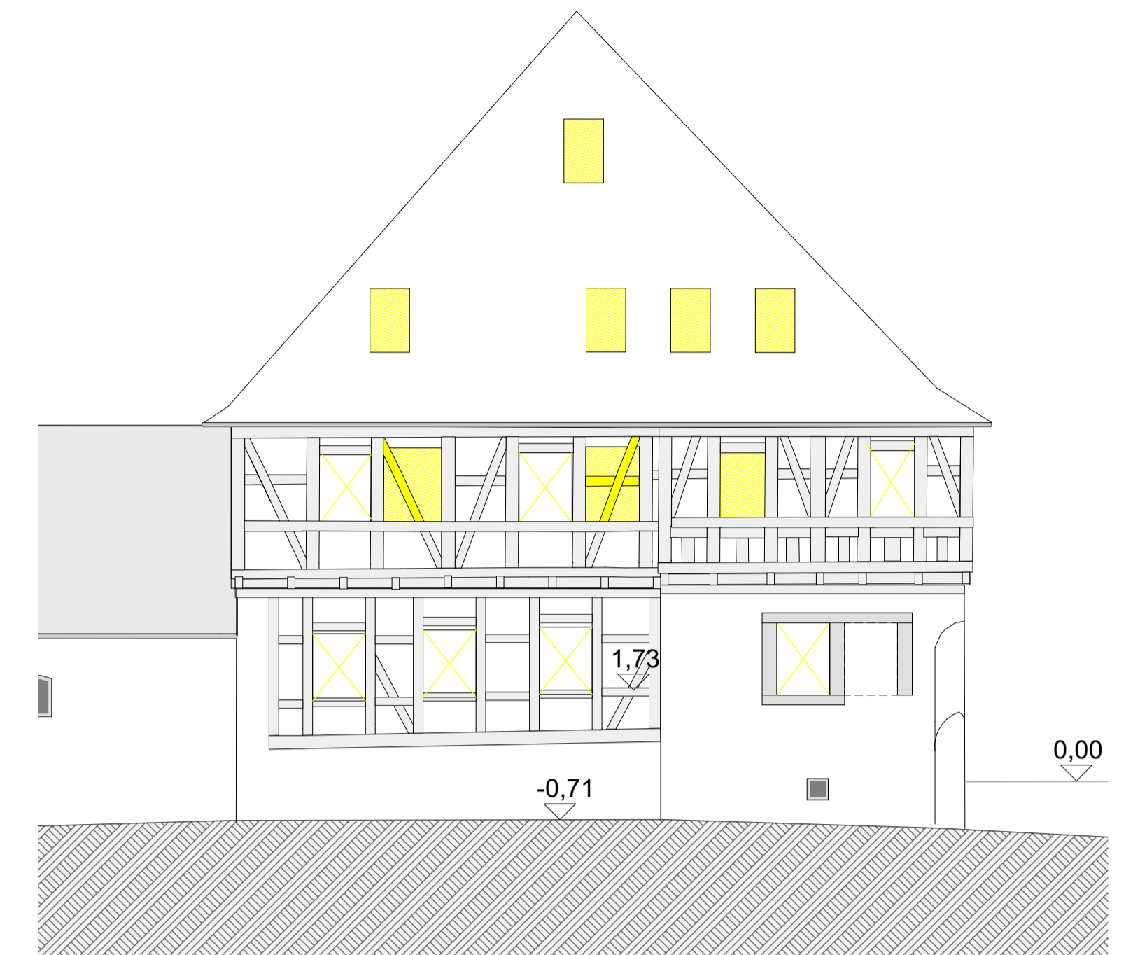
HG Westfassade Bestand mit Abriss (gelb) 1:100
